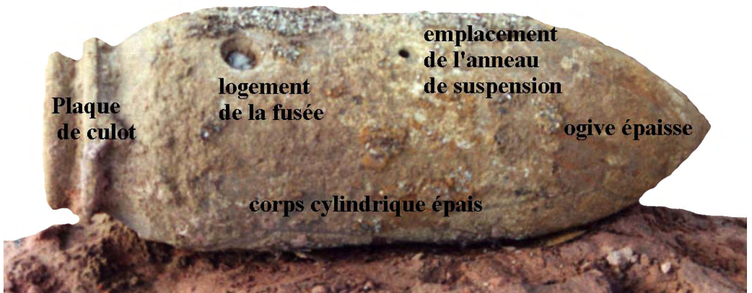
Bombe allemande de 500 kg à paroi épaisse de la seconde guerre mondiale, type SD 500
