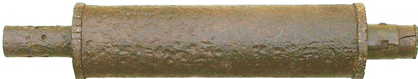
En dépit de son aspect de pot d'échappement, ce projectile explosif britannique pour mortier Stokes de 8 cm est un dangereux reliquat de la Première Guerre Mondiale.
