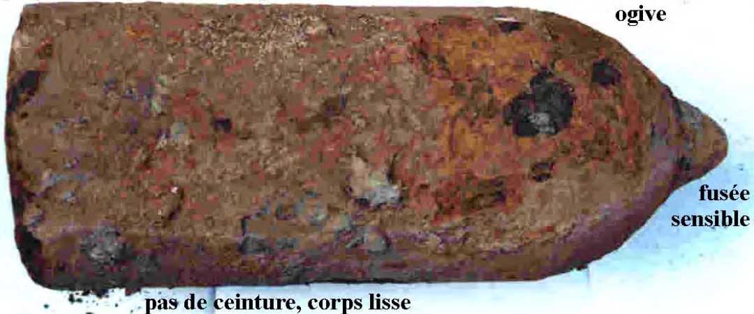
Projectile de 18 cm pour Gaswerfer, chargé en toxique suffocant ou en arsine. Un projectile similaire pour Minenwerfer de 18 cm a existé en version explosive.
