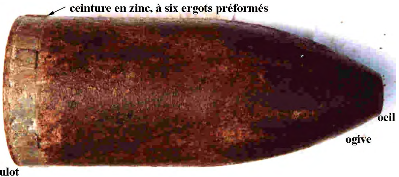
Projectile de 25 cm pour Minenwerfer lourd, chargé en toxique ou en explosif.
