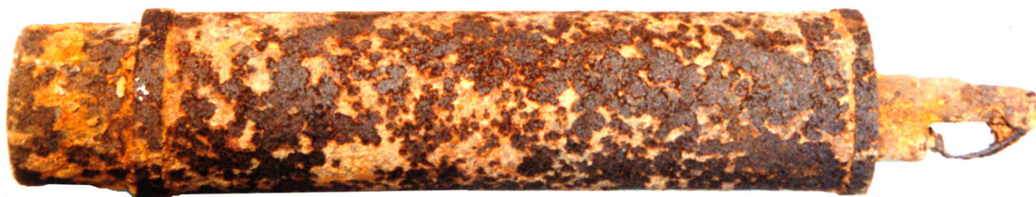
Ces projectiles britanniques pour mortier Stokes de 4 pouces sont toujours à chargement d'emploi particulier : toxique, phosphore blanc, ou agent incendiaire. Attention : la paroi cylindrique est fort mince et la corrosion n'arrange rien. En cas de fuite, il y a risque d'intoxication ou d'incendie.
